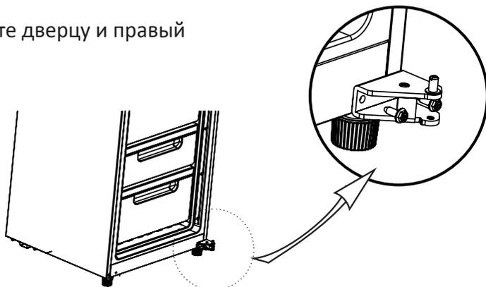
5) Переверните нижний шарнир, установите шарнирный вал с другой стороны шарнира (рис. А), установите нижний шарнир на левой стороне устройства (рис. В).
