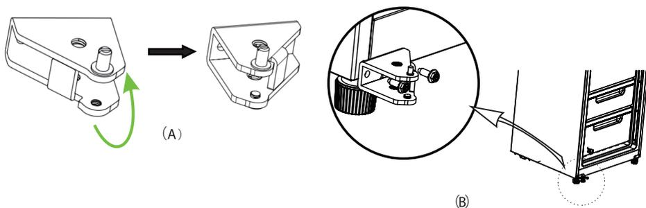
6) Установите дверцу с сигнальным проводом, изменив направление справа налево; установите верхний шарнир (рис. А). Установите декоративные планки (1), (2), (3) (рис. В).
