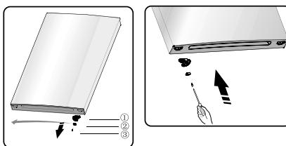
8 Ослабьте шурупы/болты, которые фиксируют среднюю петлю, и снимите среднюю петлю. Затем снимите нижнюю дверь.
