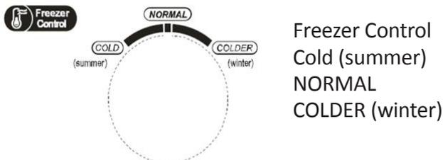
Более низкая температура соответствует положению регулятора «COLDER», а более высокая - «COLD». Обычно регулятор устанавливается в положение «NORMAL».
