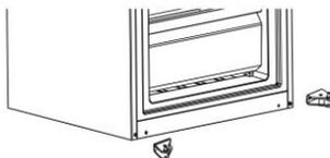
5. Снимите нижнюю петлю и установите ее в левой части корпуса.
