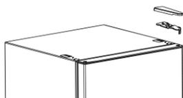
1. Снимите защитную крышку. Снимите верхнюю петлю.
