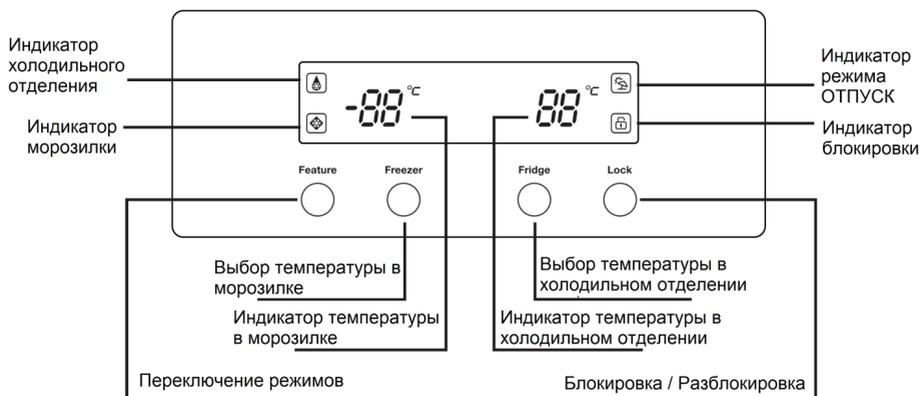
**Внимание!** Устанавливая температуру, Вы устанавливаете среднюю температуру для всего холодильника. Температура внутри каждого отделения может отличаться от значений температуры отображающихся на дисплее, в зависимости от того, сколько продуктов и где именно в холодильнике они размещены. Температура окружающей среды может также повлиять на фактическую температуру внутри холодильника.
